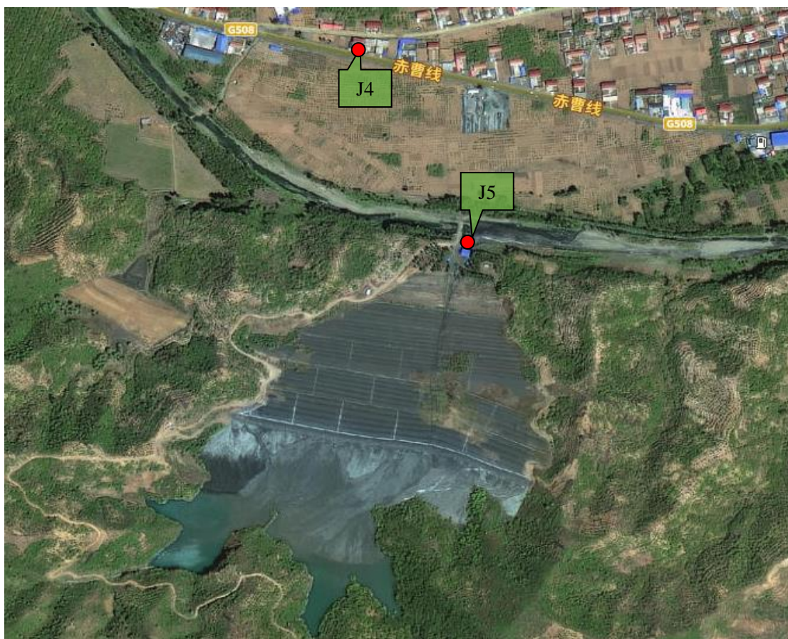
图 5.2-36 尾矿库地下水监测井布设图
